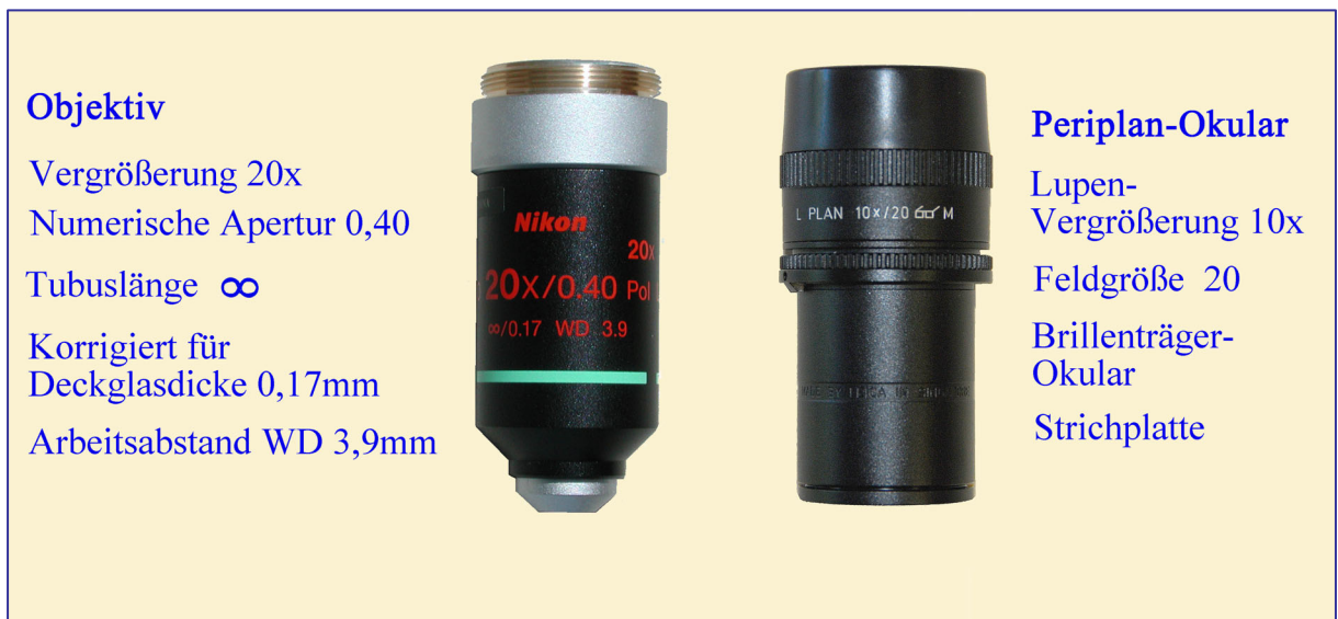
Abbildung 1-5. Objektiv (Beispiel: Nikon CFI Achromat 20x P) und Okular (Beispiel: Leica Periplan mit Strichplatte)
